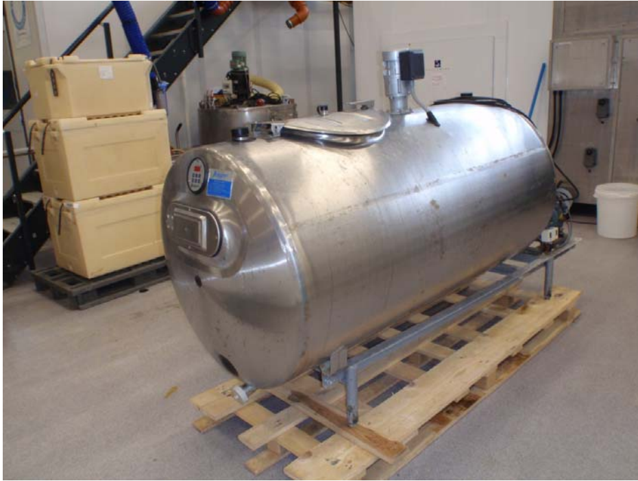
Bilde 1 Kjøletanken som ble benyttet til RSW-kjøling.
